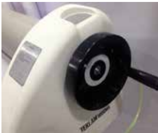
Sistema de manivela para mover el material
