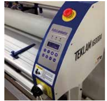
Sistema de control de temperatura y velocidad digital
