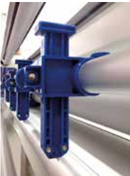
Sistema de cuchillas de corte sobre guía graduada
