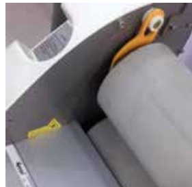
Sistema de soporte y sujeción de reposo de los rodillos de silicon
